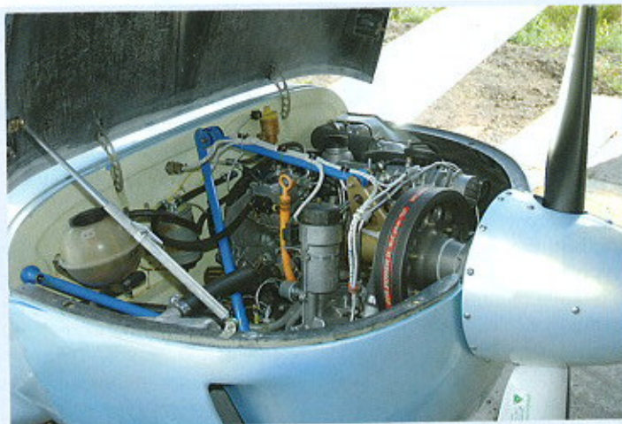
Volkswagenin diesel toimii Varttimarkan voimanlähteenä. Kolme hihnaa toimii alennusvaihteena. CNC-sorvatuille hihnapyörille on oma jäähdytysilmanotto. Varsinainen jäähdytys pilkistää suuremman ilmanottoaukon yläpuolella.
