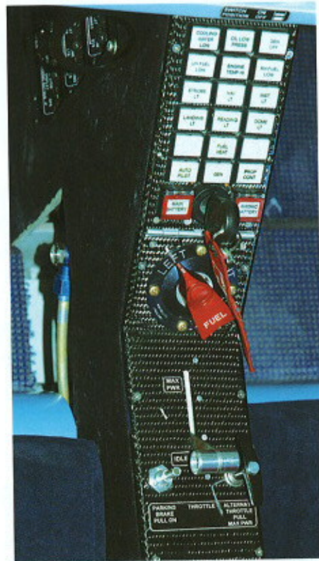
Kaasu on sijoitettu keskelle. Pysäköintijarru ja mekaaninen varalla oleva tehonsäätö ovat sen vieressä.
